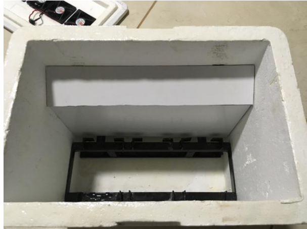
Figura 8 - Estrutura Interna Completa com Placas de PVC Montadas
