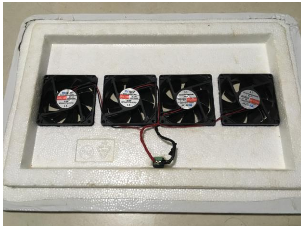
Figura 6 - Tampa da Caixa com Coolers Montados
